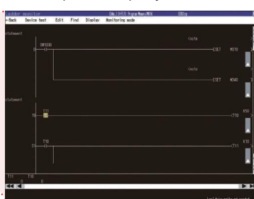
Локалізація проблемної ділянки та безпосереднє редагування Ladder
